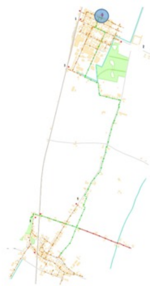
Fig.3 – Planimetria del sistema di protezione catodica con ubicazione impianto a corrente impressa
