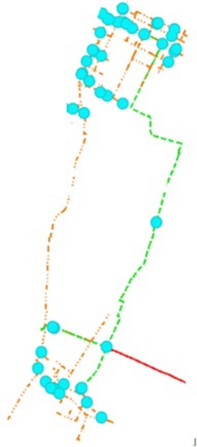
Fig.3a – Planimetria con ubicazione dei giunti isolanti e punti di misura del potenziale
