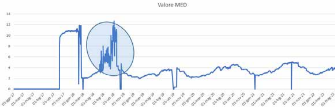
Fig. 11 - Andamento valori medi di corrente in impianto a corrente impressa dal 2018 al 2022
