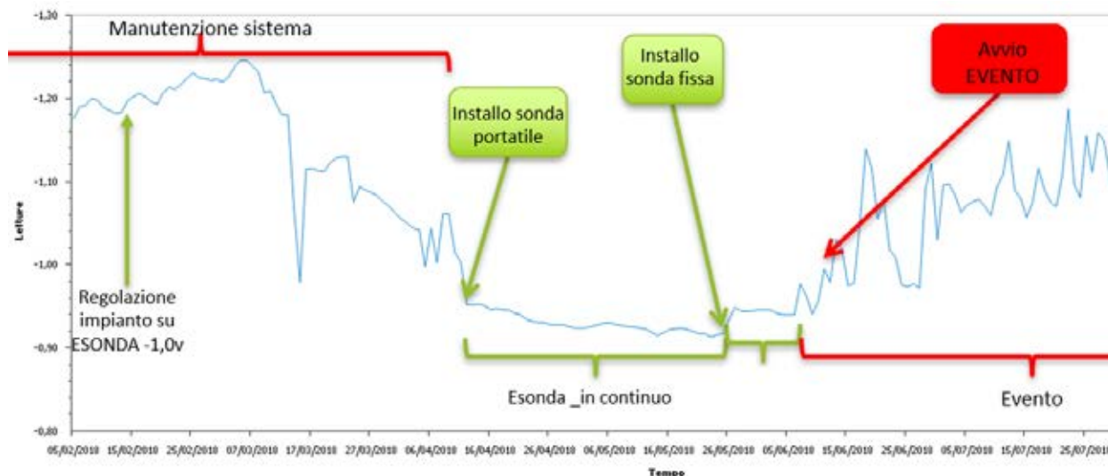
Fig. 2 - Andamento valori di potenziale medi del punto critico – da monitoraggio in continuo
