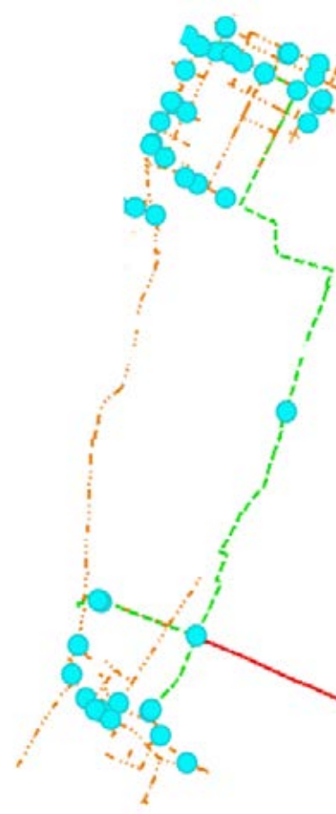
Fig. 1a – Planimetria con ubicazione dei giunti isolanti e punti di misura del potenziale
