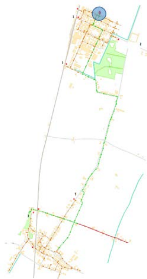
Fig. 1 – Planimetria del sistema di protezione catodica e ubicazione impianto a corrente impressa
