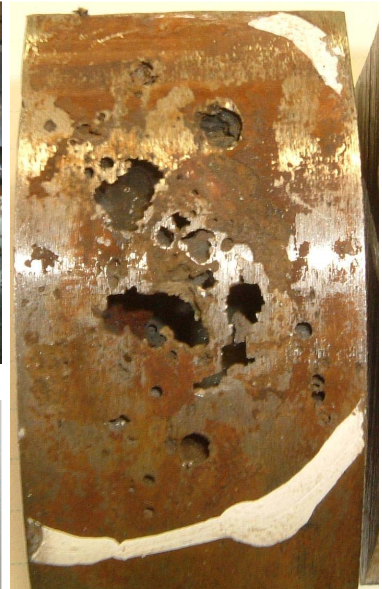
Pitting diffuso su tutta la superficie dell'asse
