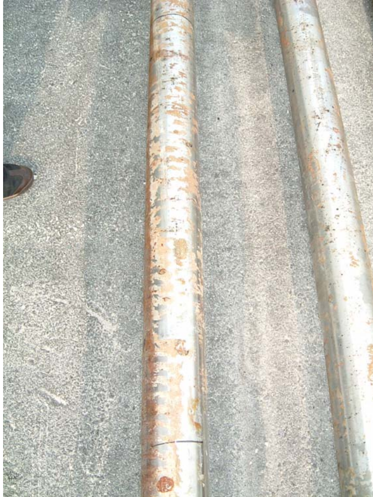
punti di attacco per pitting su spezzoni di asse porta-elica
